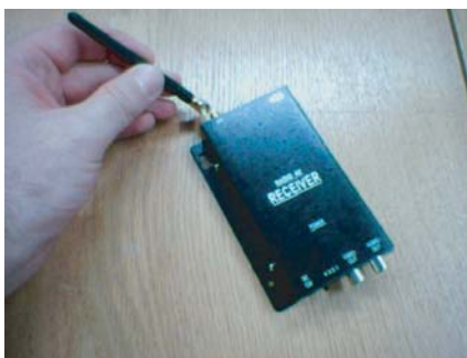
FIG. 4.2 – Installation de l'antenne du récepteur
